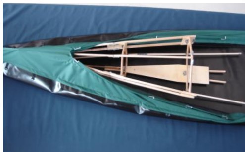
( Bild 7) Einschieben der Gerüstspitzen
